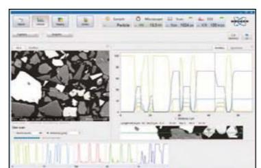
분석을 하고자 하는 영역에 대하여 선을 그린 후 Line을 따라 관심 있는 영역에 대한 원소 차이를 Line Profile로 쉽게 비교 분석
