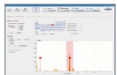
빠르고 정확한 정성·정량 분석 결과를 제공하며 면, 점, 등 원하는 영역 등을 지정하는 다양한 방법으로 시료 표면의 성분 분석이 가능·중복된 Peak를 자동으로 분리하여, 신뢰성 있는 분석 결과 제공
